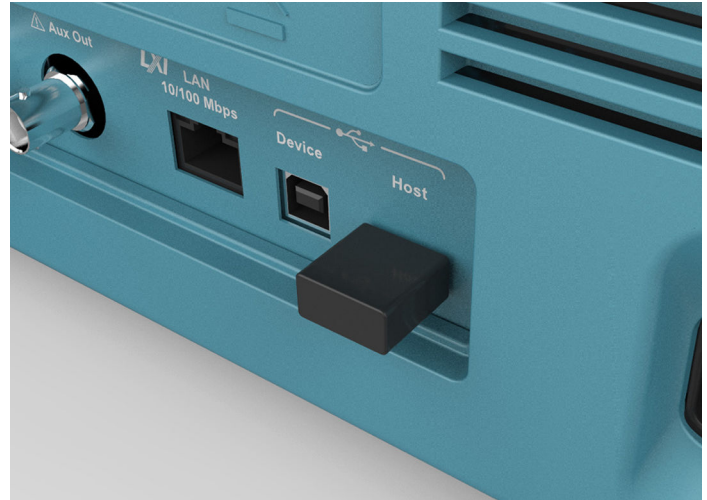
Рисунок 10. Wi-Fi-адаптеры, конфигурация которых устанавливается во встроенных меню настроек, поддерживают постоянное беспроводное соединение
