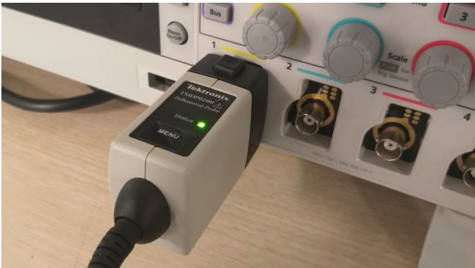
Рисунок 9. Пробники TekVPI передают прибору TBS2000B настройки масштабирования, диапазоны и информацию о состоянии.
